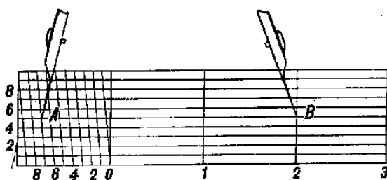
Рис. 11. Измерение расстояний по поперечному масштабу
